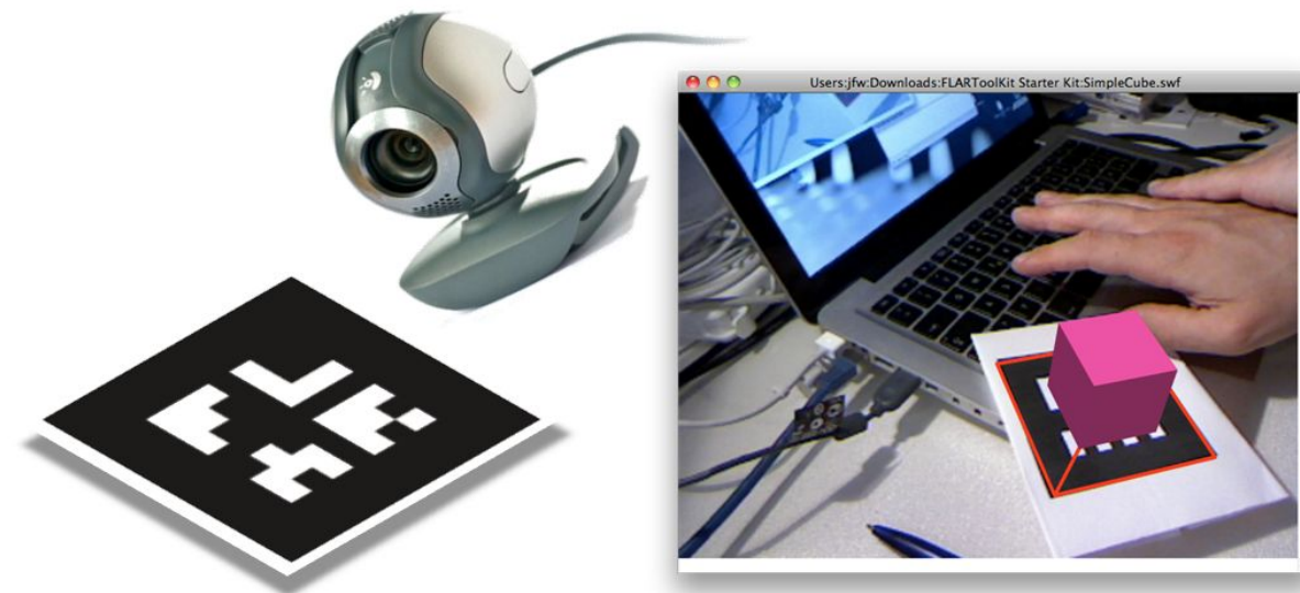
Abbildung 1: Position und Lage des Markerkärtchens im Bild der Webcam werden von der Software registriert. In einem virtuellen Koordinatensystem, dessen eine Achse senkrecht zum Marker steht, können virtuelle Objekte platziert werden.
