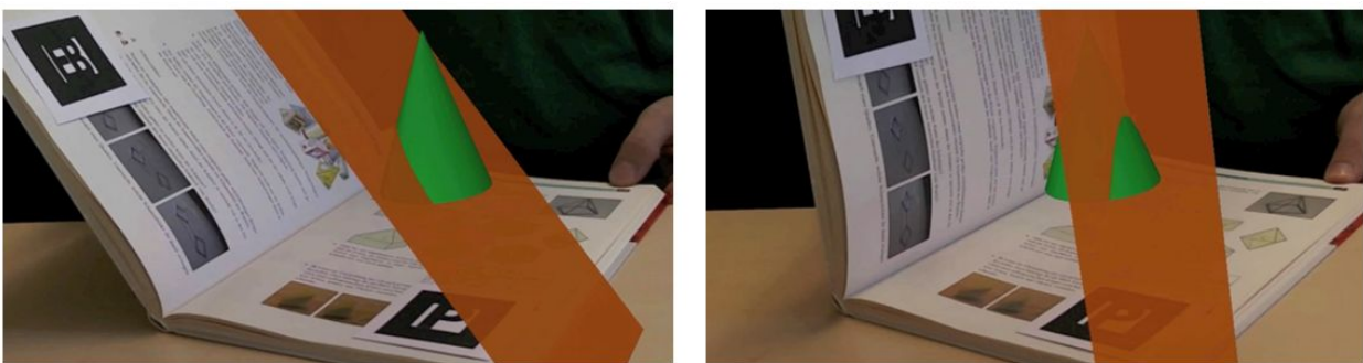
Abbildung 3: Auf zwei Markerkärtchen werden zwei virtuelle Objekte aufgerechnet, deren Bezugssysteme unabhängig voneinander in der realen Szene bewegt werden können. Auf diese Weise können verschiedene Schnittkonstellationen hergestellt und beobachtet werden.
